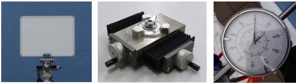
Abb. 1: a) Zieltafel, b) XY-Schlitten, c) Feinmessuhr
