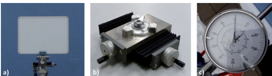
Abb. 1: a) Zieltafel, b) XY-Schlitten, c) Feinmessuhr
